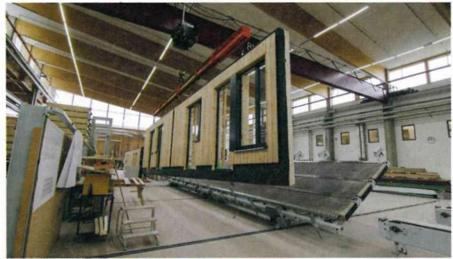
**Bild 7** Werkseitige Vorfertigung
