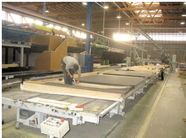
**Bild 4 Die Fertigung unterschied sich durch nichts, außer die Heizregister und die Distanzfutter, vom eingübten Holztafelbau.**
